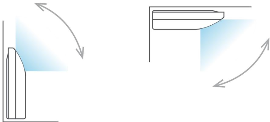
Расположение внутреннего блока в помещении может быть как горизонтальным (у потолка), так и вертикальным (на стене).
